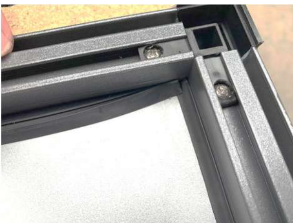
5. Detailansicht: Ein Ende der Keildichtung im Profil
