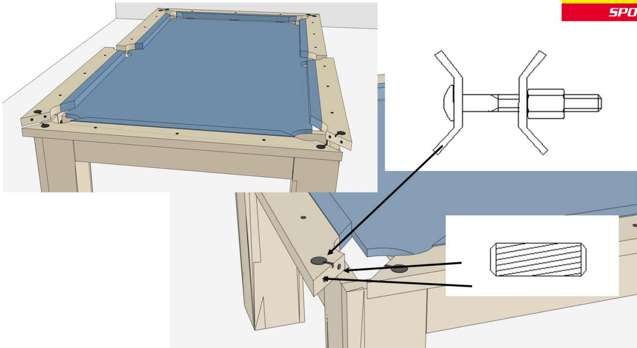
Zur Montage des Bandenrahmens legen Sie die einzelnen Teile, wie abgebildet mit der Unterseite nach oben auf den Tisch und fügen Sie diese mit den Klemmschrauben und Holzdübeln zusammen.
