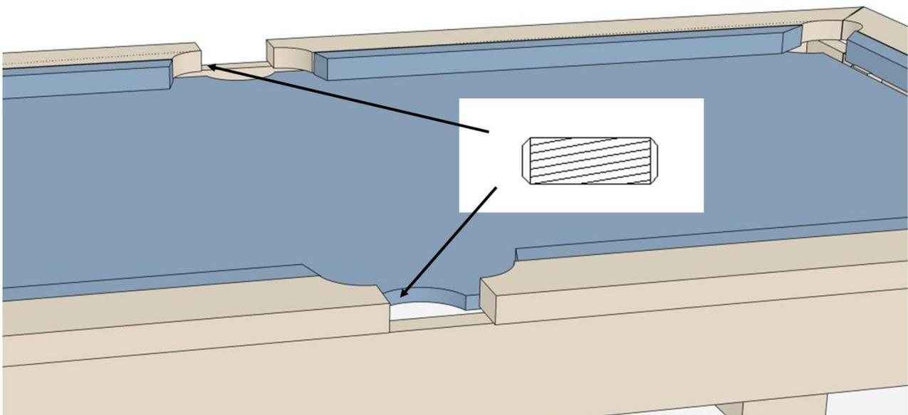
Drehen Sie danach die Teile des teilweise montierten Bandenrahmens auf die richtige Seite (Montageseite nach unten), fügen an den Mittellöchern die Holzdübel ein und schieben Sie die beiden Hälften nach der Mitte hin zusammen. Positionieren Sie dann den Bandenrahmen an die richtige Position, die Ihnen die endgültige Montage des Rahmens, ausgehend von der Unterseite des Tisches, ermöglicht. (Sehen Sie dazu auch die folgende Abbildung !)
