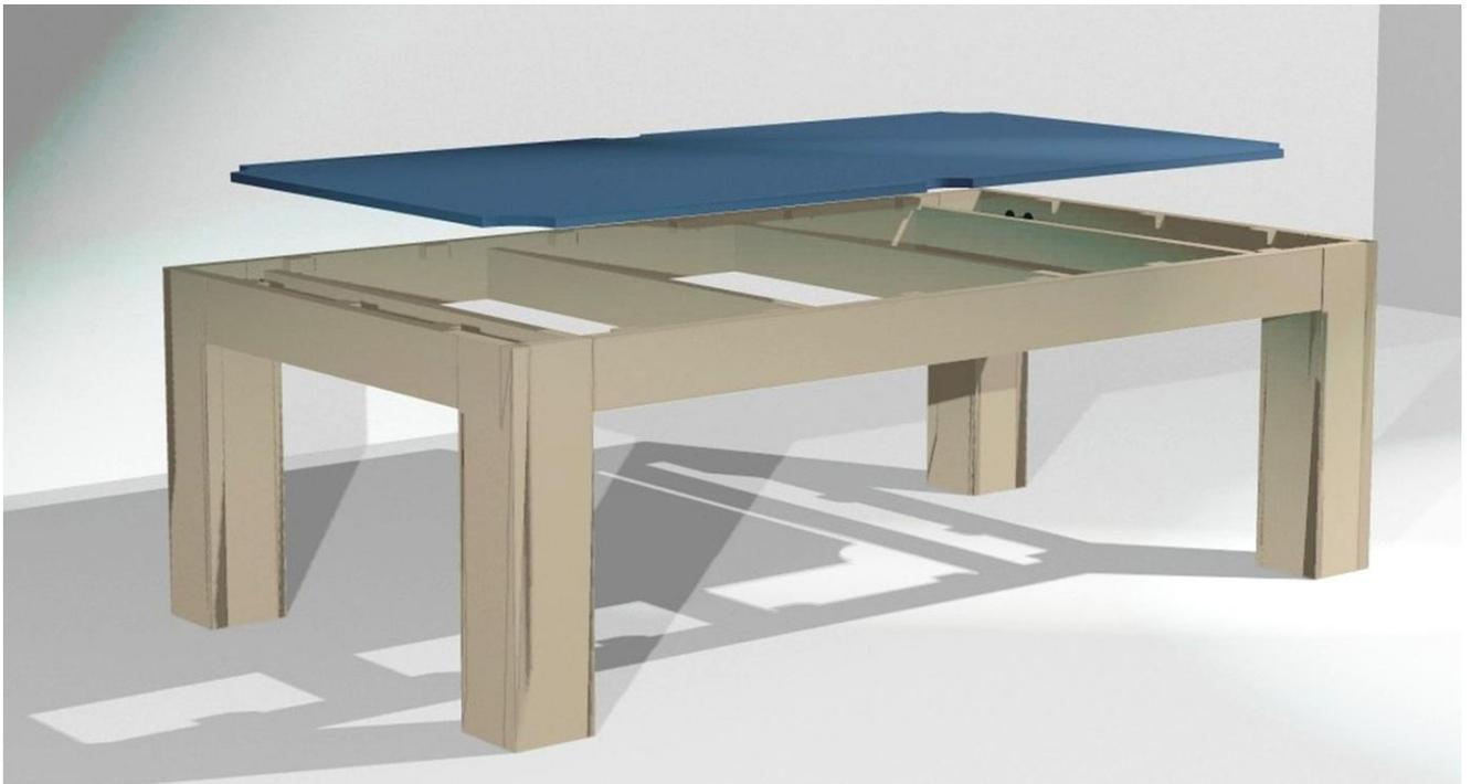
Legen Sie nun die Schieferplatte, wie oben in der Abbildung gezeigt, in den fertig montierten Rahmen ein.
