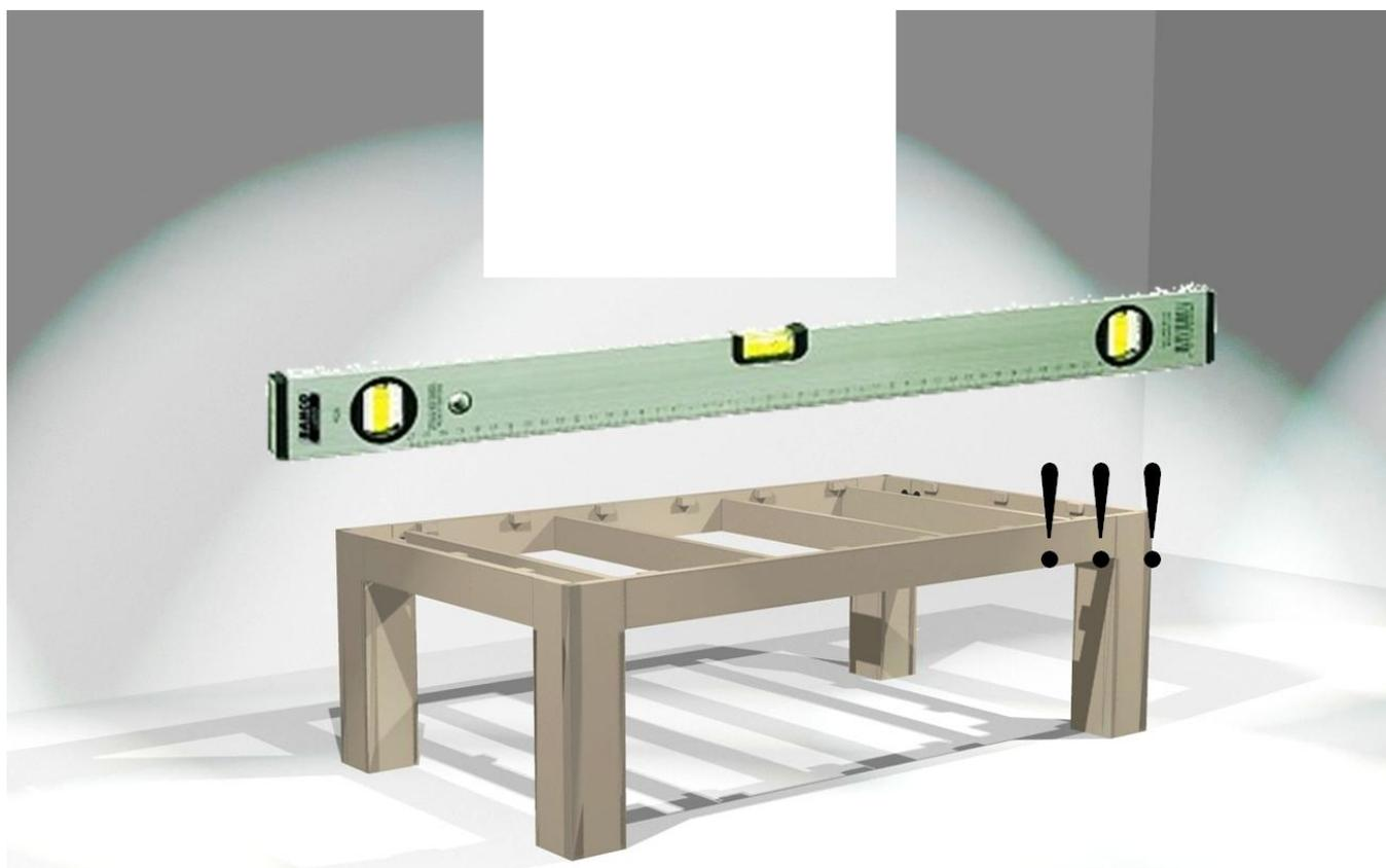
Stellen Sie nun den zusammengefügtten Rahmen des Tisches am endgültigen Aufstellplatz auf und achten Sie darauf, daß der Tisch exakt gerade steht. Verwenden Sie dazu eine Wasserwaage und justieren Sie den Tisch mit den vier höhenverstellbaren Drehfüßen in den Tischbeinen.
