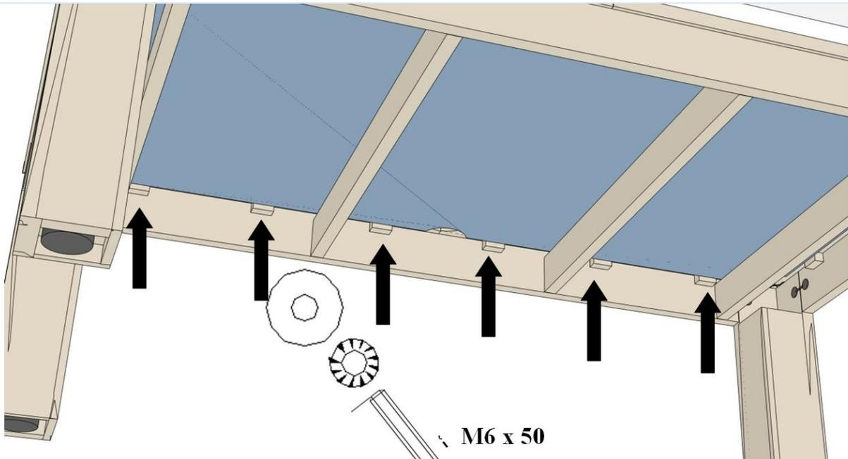
Wie abgebildet, verschrauben Sie jetzt den Bandenrahmen mit dem Rahmen des Tisches. Achten Sie bitte dabei auf die exakte Paßgenauigkeit der Bandenteile an der Oberseite, so daß alle Bandenteile in gerader Linie zueinander liegen.
