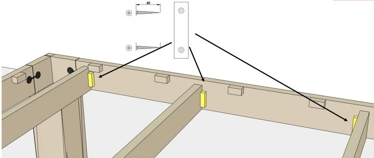
Fixieren Sie jetzt die Querträger des Tischrahmens, wie oben abgebildet, mit den beiliegenden Holzklötzen und den 40 mm langen Schrauben.
