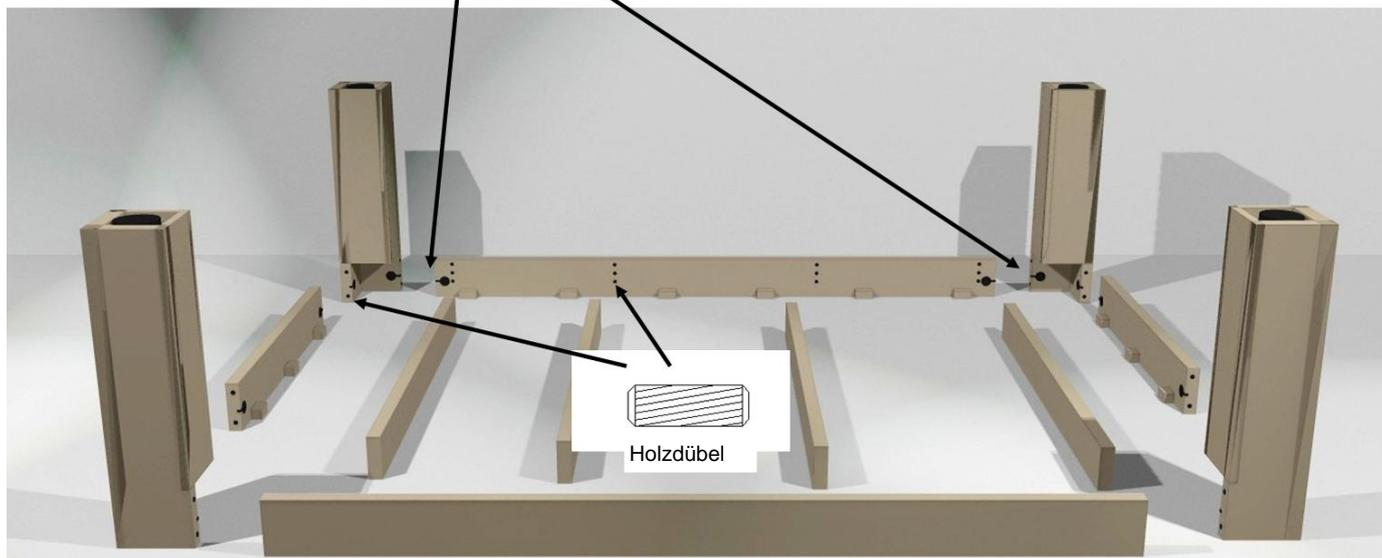
Sortieren Sie zunächst die einzelnen Bauteile und legen Sie diese, wie oben abgebildet, an dem Aufstellplatz so ab, daß Sie die Montage leicht durchführen können. Zur leichteren Zuordnung sortieren Sie auch das Montagematerial ( Schrauben ,Klemmschrauben, Holzdübel usw.) . Verschrauben Sie nun die Holzteile des Billardtisches unter Zuhilfenahme der Klemmschrauben und Holzdübel, wie oben abgebildet.
