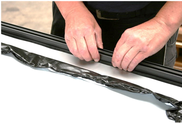
7. Die Dichtung nun vollständig in das Profil drücken
